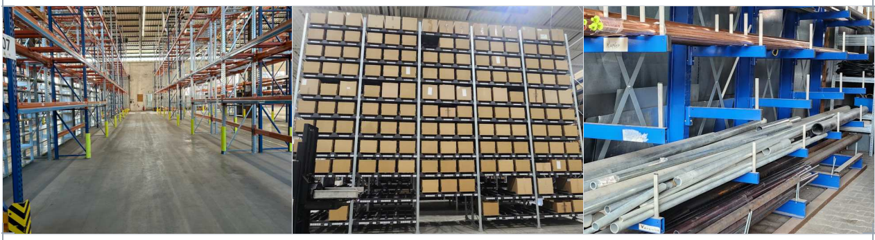
Abb. 1 – Regalbauarten im Betrieb: Palettenregal, Fachbodenregal, Kragarmregal. Gemeinsame Bauteile: Ständerrahmen, Traversen, Diagonalverbände, Fußplatte und Bodenverankerung.
