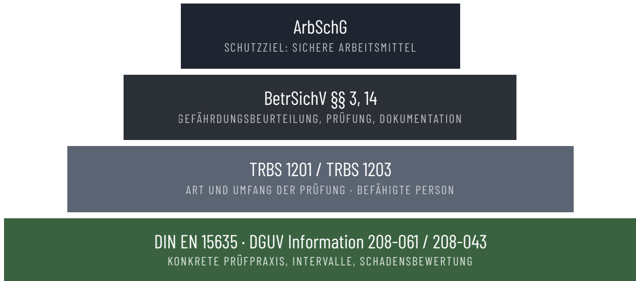
Abb. 4 – Normenpyramide: vom gesetzlichen Schutzziel zur anwendbaren technischen Regel.
